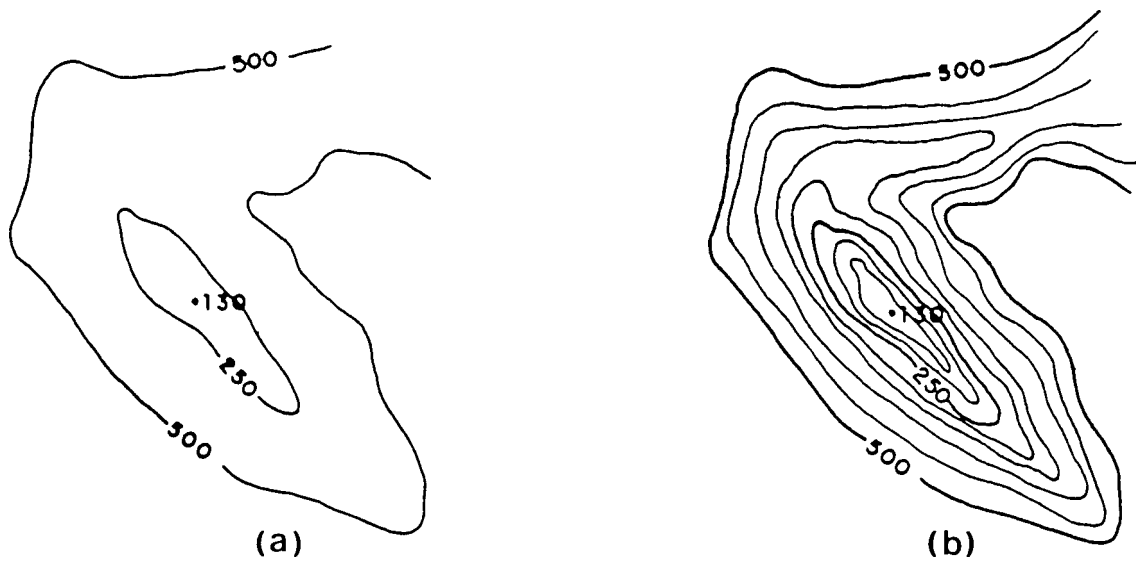
Figura 38.23 - Representação de um Acidente Submarino em uma Carta Náutica Convencional e em uma Carta Batimétrica
