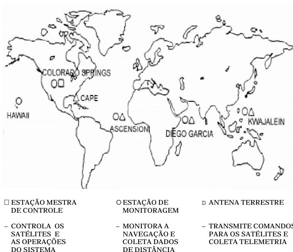
Figura 37.5 - Segmento de Controle do Sistema GPS
